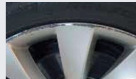
Poškodenie okraja ráfika
